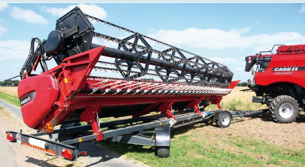
Hohe Spurtreue dank Allradlenkung: der Leguan Quattro von TAM. Fotos: Eikel
